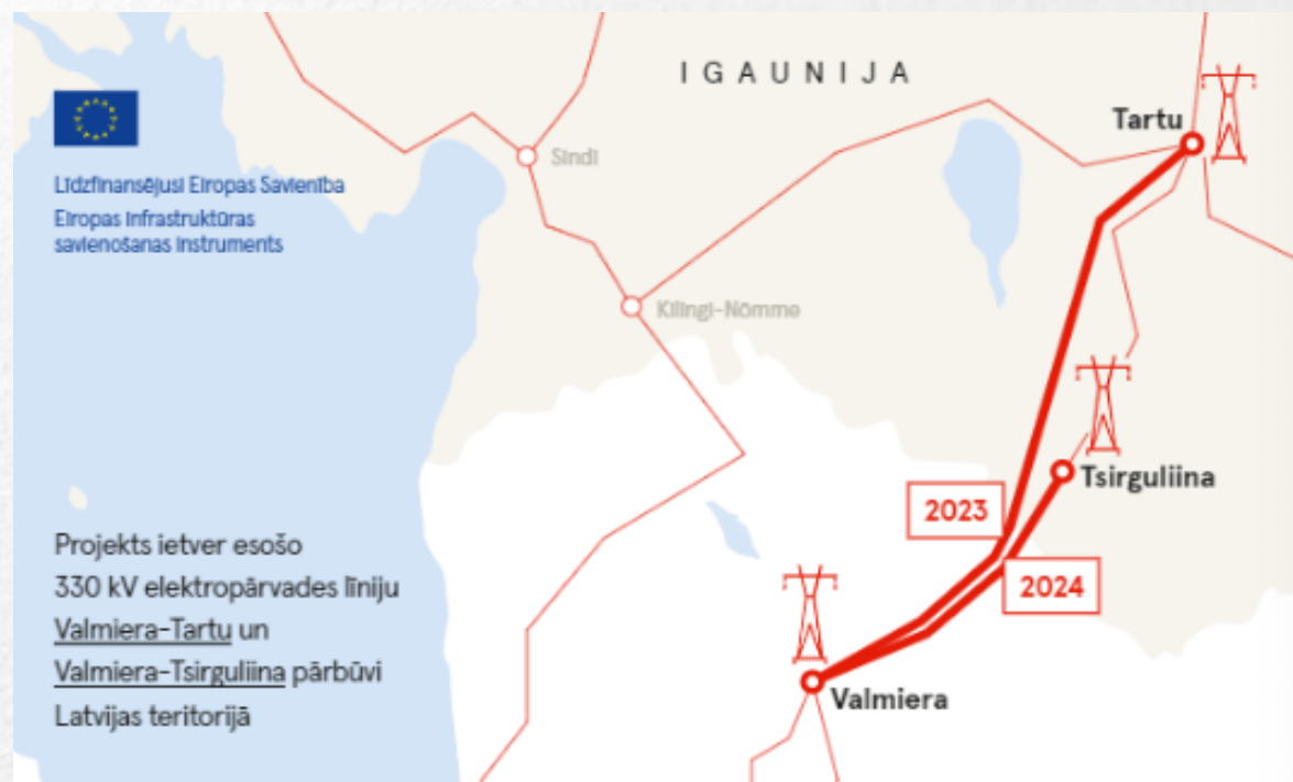
Esošo divu 330 kV līniju rekonstrukcija uz EE-LV robežas
