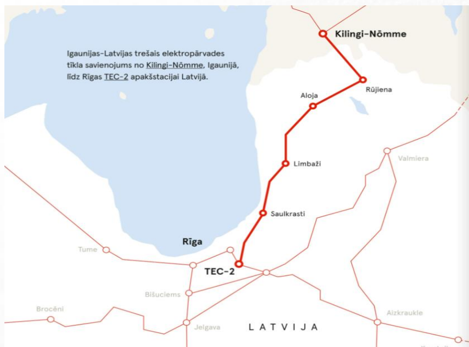
Jaunas trešās 330 kV līnijas izbūve uz EE-LV robežas (2021)
