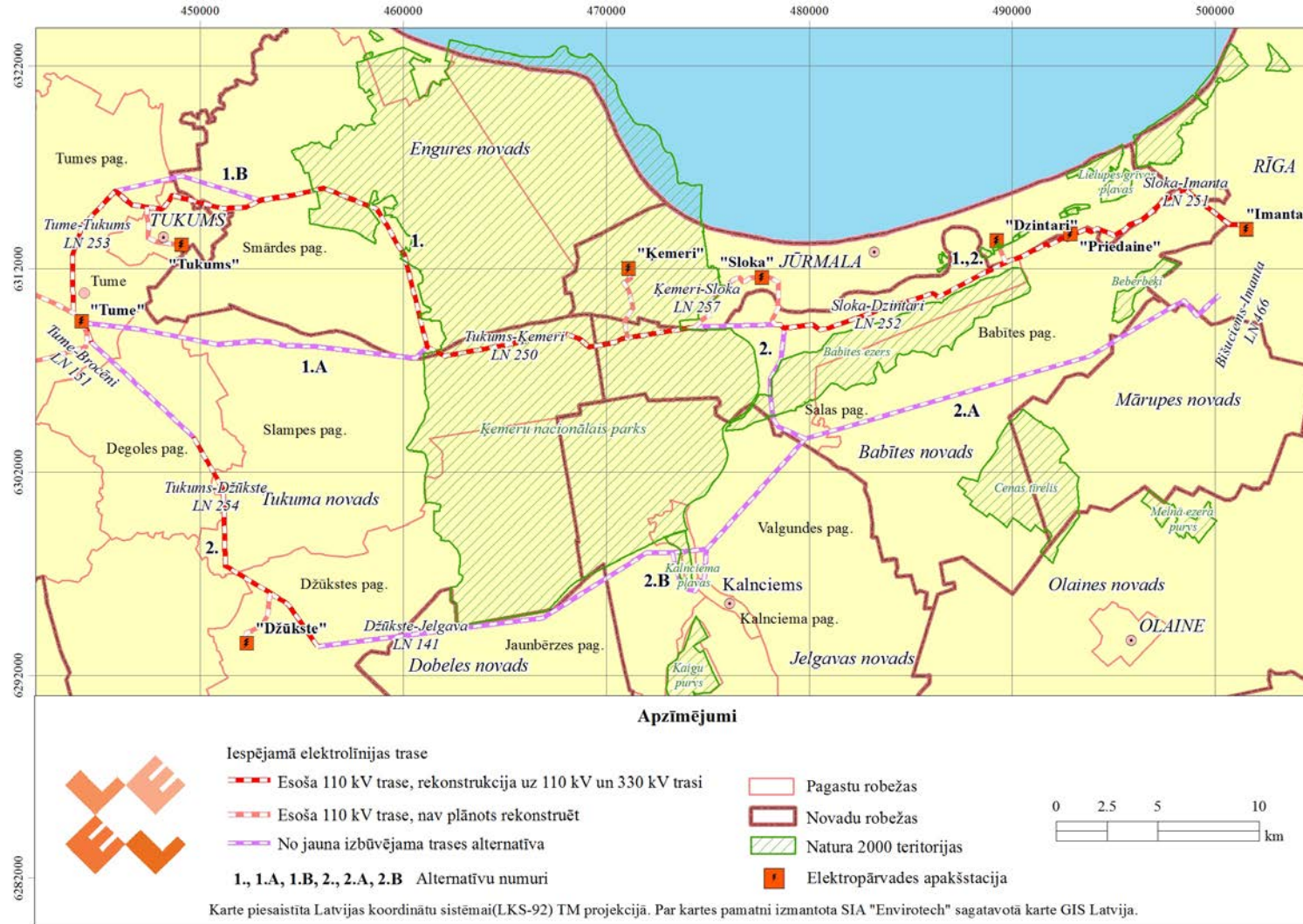
2. attēls. Elektropārvades tīklu savienojuma „Kurzemes loks” 3. posma alternatīvu trases un šķērsojamās pašvaldības
